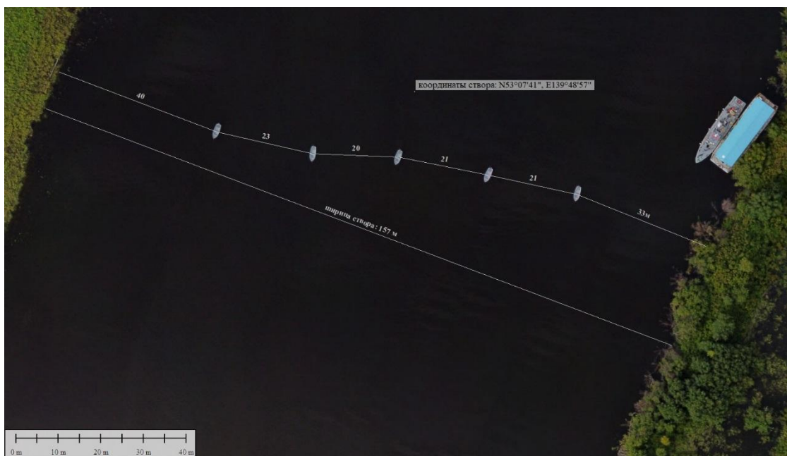
Рис. 2. Схема расстановки акустического комплекса в протоке Тахтинской в 2022 г. Fig. 2. Scheme of sonar complex mounted in the Takhtinskaya channel in 2022
