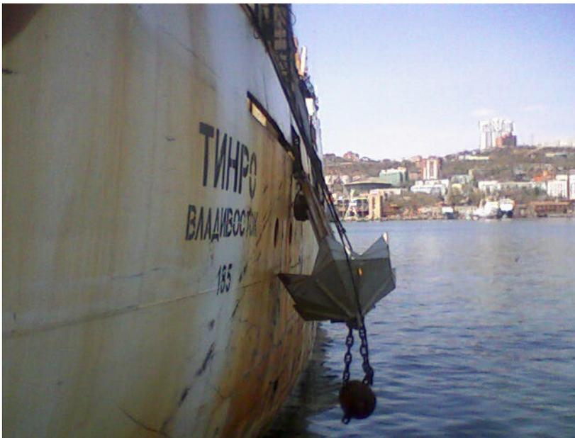
Рис. 3. Крепление якоря по-походному на борту НИС «ТИНРО»
