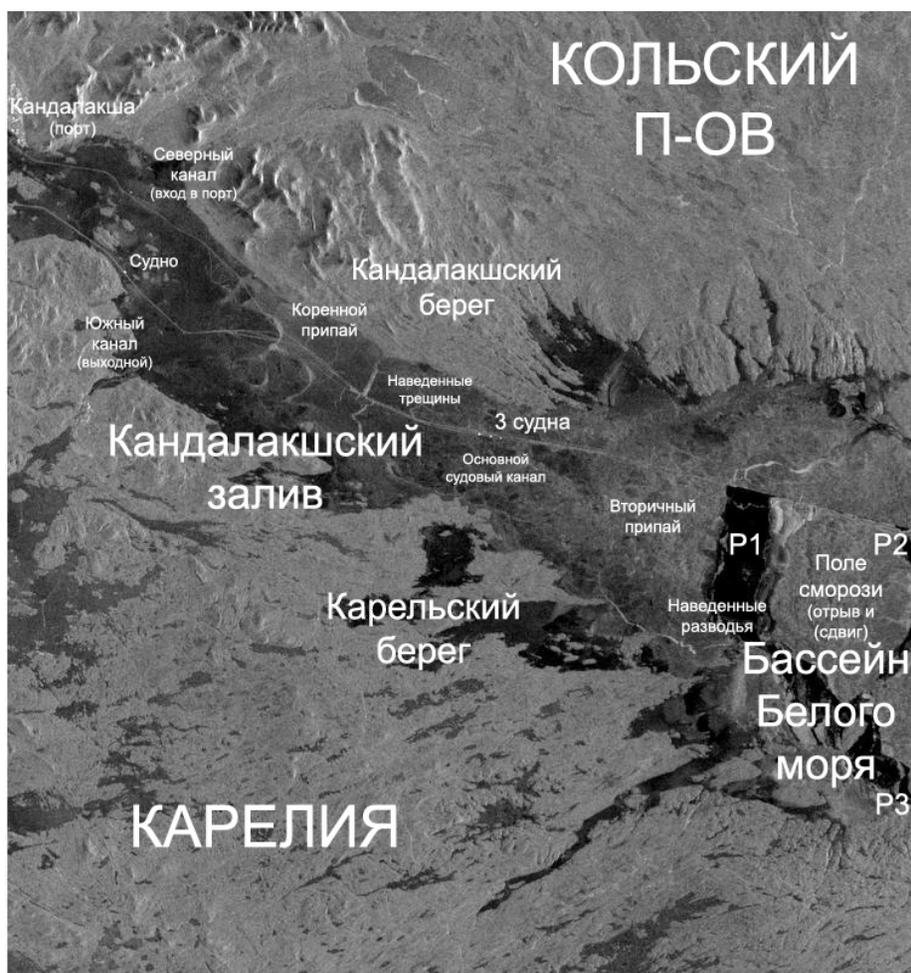
Рис. 7. Результаты трасологического дешифрирования РСА-изображения Кандалакшского залива, где в результате судоходства происходит взлом припая и образование обширных полыней и разводий (P<sub>1</sub>–P<sub>3</sub>). Envisat-1, 6 марта 2009 г.
