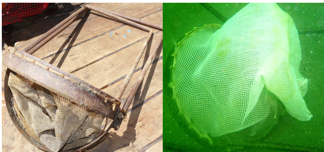
Рис. 7. Водолазный ручной модифицированный дночерпатель (Аверинцев и др., 1982) в сложенном (слева) и в рабочем положении перед взятием пробы (справа)
