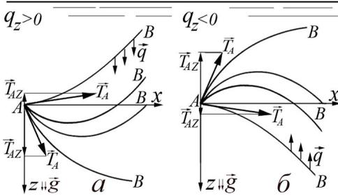
Рис. 1. Формы каната в воде: **а** — с положительной и **б** — с отрицательной плавучестью
