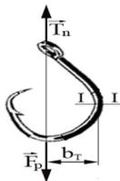
Рис. 7. Силы, приложенные к рыболовному крючку:  $\bar{T}_n$  — натяжение поводца;  $\bar{F}_p$  — усилие рыбы;  $b_T$  — плечо натяжения поводца относительно наиболее нагруженного сечения крючка I-I
