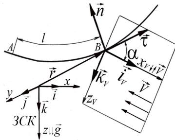
Рис. 2. Земная  $\vec{i}\vec{j}\vec{k}$ , поточная  $\vec{i}_V\vec{j}_V\vec{k}_V$  и естественная  $\vec{t}\vec{n}\vec{b}$  системы координат гибкого каната:  $\vec{V}$  — скорость воды относительно каната (скорость потока); ЗСК — земная система координат
