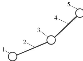
В этой модели трал заменяется материальной точкой, четыре кабеля — одним прямолинейным стержнем, две траловые доски — материальной точкой, два ваера — жестким стержнем, судно — материальной точкой. Что общего с реальной траловой системой (см. рис. 3) имеет механическая система, изображённая на рис. 4 и используемая в учебниках\*?
