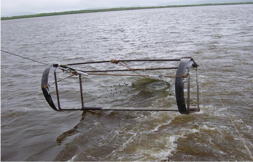
Рис. 1. Внешний вид бим-трала, использованного в съемке
