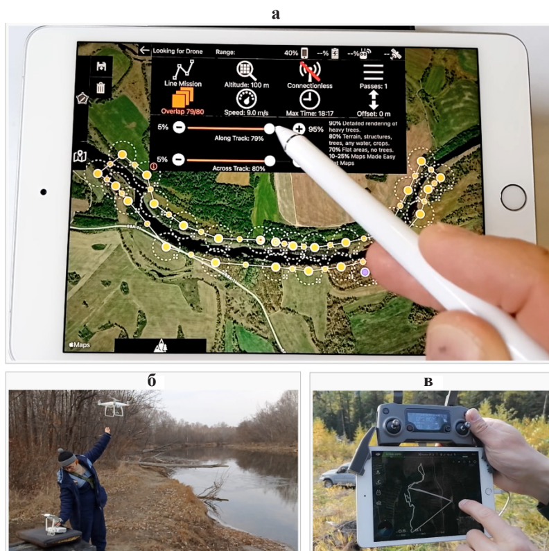
Рис. 3. Работа оператора БПЛА на контрольном участке: ситуационная корректировка настроек миссии в полетном ПО Map Pilot Pro (а), запуск беспилотника из позиции удержания одной рукой (б), отслеживание поступающего видеосигнала и телеметрии для обеспечения безопасности полета (в)
