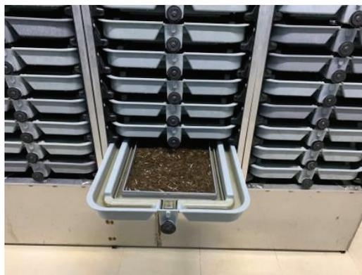
Рис. 3. Вертикальные инкубационные аппараты на ЛРЗ Лазовой
