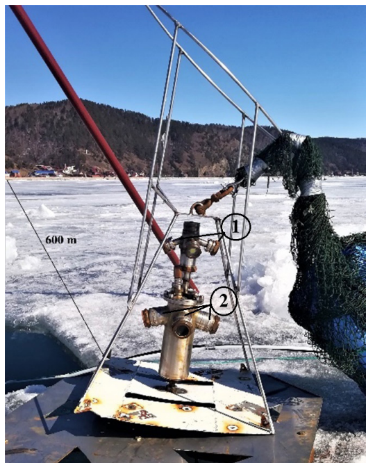
Рис. 1. Установка видеосистемы со льда (на дальнем плане пос. Листвянка): 1 — боксы для подсветки; 2 — боксы для видеокамер (фото из архива Байкальского музея)
