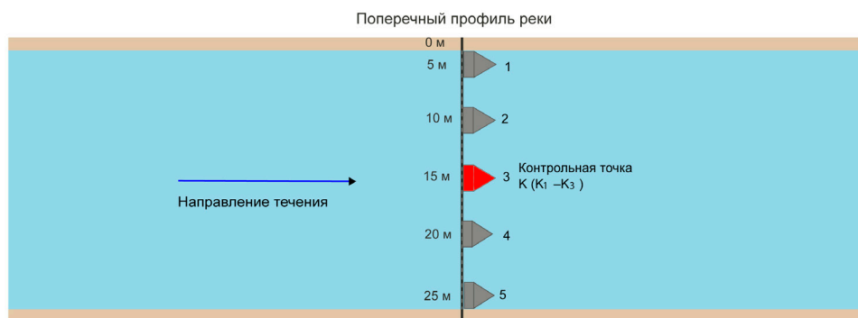
Рис. 1. Обобщенная схема размещения ловушек в поперечном профиле реки при проведении учетных и специальных обловов молоди тихоокеанских лососей: № 1–5 соответствуют позициям ловушек; центральная позиция К (№ 3, красная ловушка) — контрольная точка, используемая для определения динамики миграции при учетных обловах (К) и доли облова (р) при спецобловах ( K_1 – K_3 ), см. пояснения в разделе Терминология
